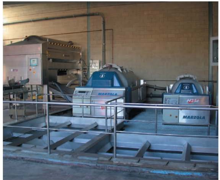
Las prensas neumáticas favorecen un prensado suave y adecuado
